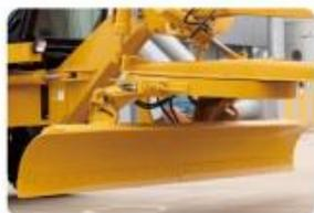
A ação da lâmina é controlada por pressão hidráulica total e a lâmina tem rotação de 360 graus, expansão telescópica e contração e movimento lateral de 90 graus, o que maximiza a operação.
