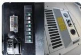
Painel de controle simples para fácil operação. O sistema de ar condicionado permite o rápido ajuste da temperatura da cabine.
